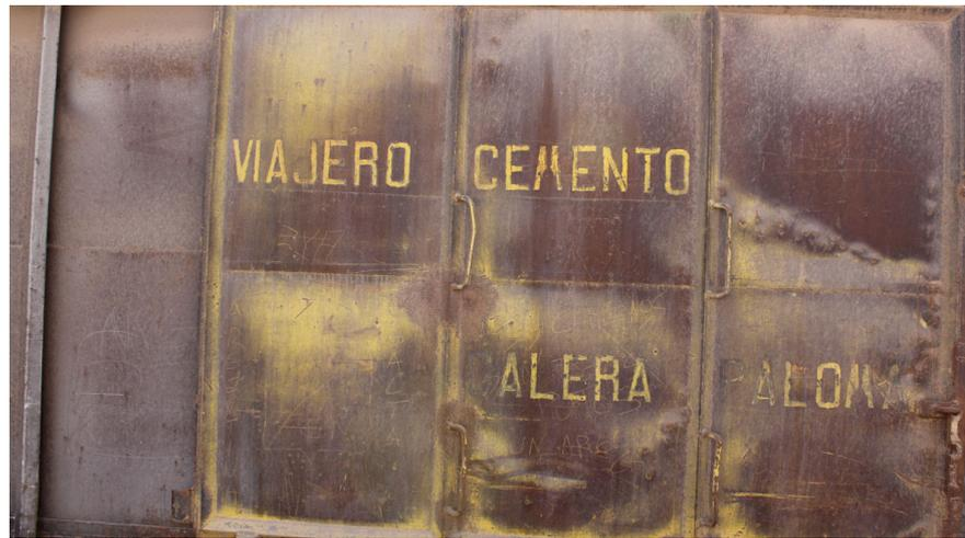
**Ilustración 20** - Puerta de carro bodega de 11 metros, interzonal, asignada al transporte de cemento en sacos para la red norte. Baquedano 2018.
