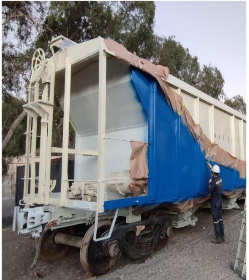
**Ilustración 43** - Proceso de pintado de zócalos con color azul RAL-5017.
