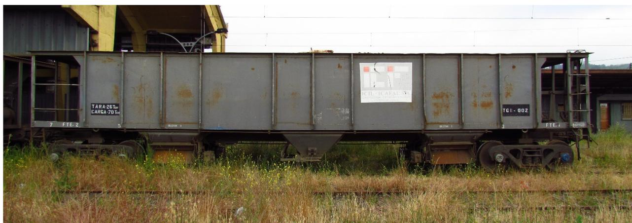
*Ilustración 37 - Carro EGG transformado a tolva abierta para el traslado y botadura de piedra balasto. Temuco 2010.*
