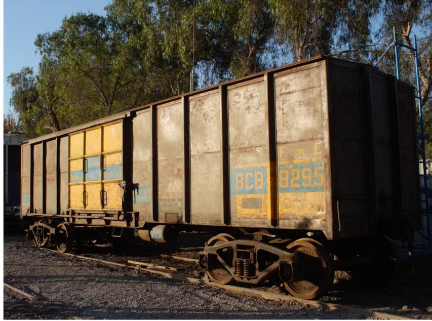
**Ilustración 22** - Carro completamente lijado en su estructura.
