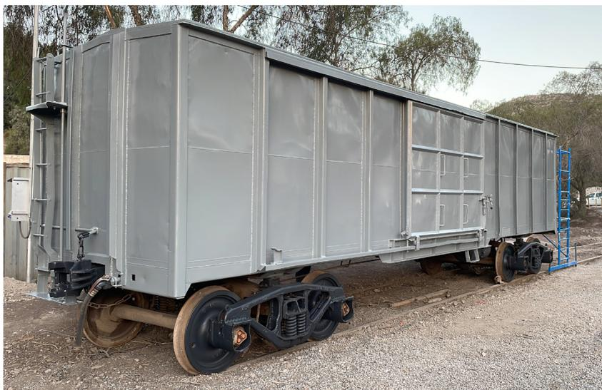
**Ilustración 27** - Carro bodega completamente pintado en color gris, correspondiente a RAL-7046 Telegrey2.
