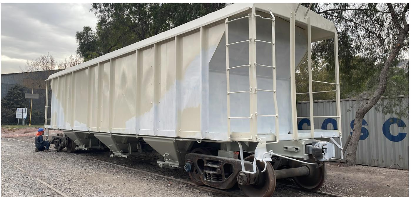
**Ilustración 42** - Carro tolva con capa de imprimante epóxico.
