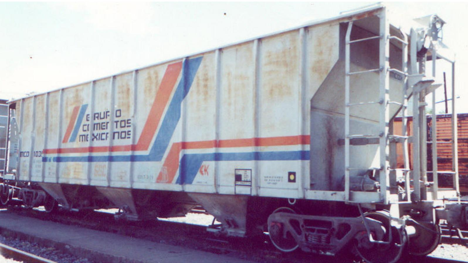
*Ilustración 34 - Tolva PS2-2893 en operación para los ferrocarriles de México. c1990.*
