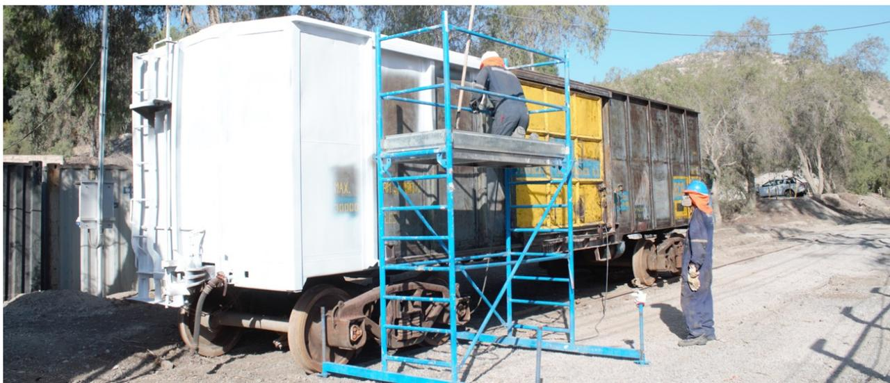
**Ilustración 28** - Carro bodega en proceso de imprimado con pintura epóxica.
