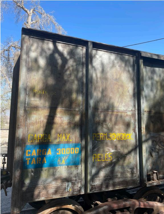
**Ilustración 23** - Carro bodega con decapante aplicado.
