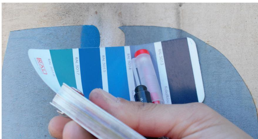
**Ilustración 14** - Obtención de colores mediante el uso de cartilla RAL, luego de un suave pulido se logra revivir el color observado, posterior a esto se envían los códigos de color para ser igualados por el fabricante de pintura.
