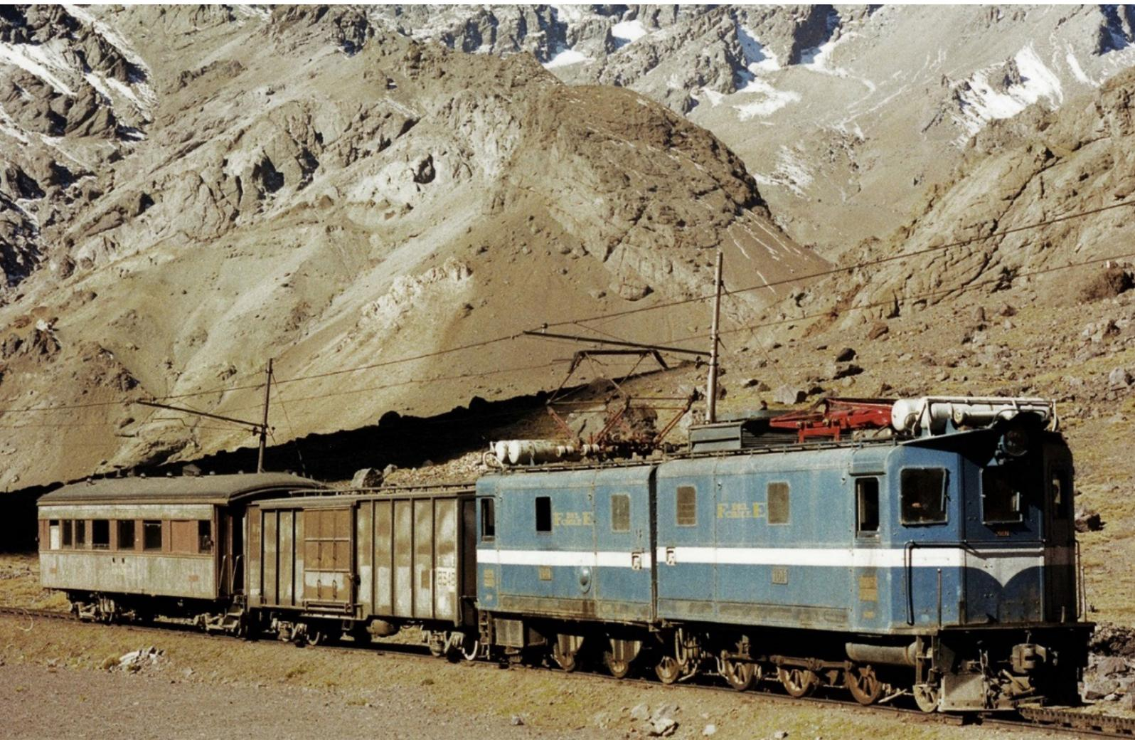
*Ilustración 18 - Tren internacional proveniente de Argentina con carro bodega bitrocha de 11 metros. Juncal 1976.*
