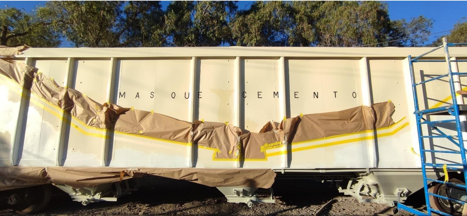
**Ilustración 48** - Carro en proceso de enmascarado, con el eslogan ya pintado a pincel.
