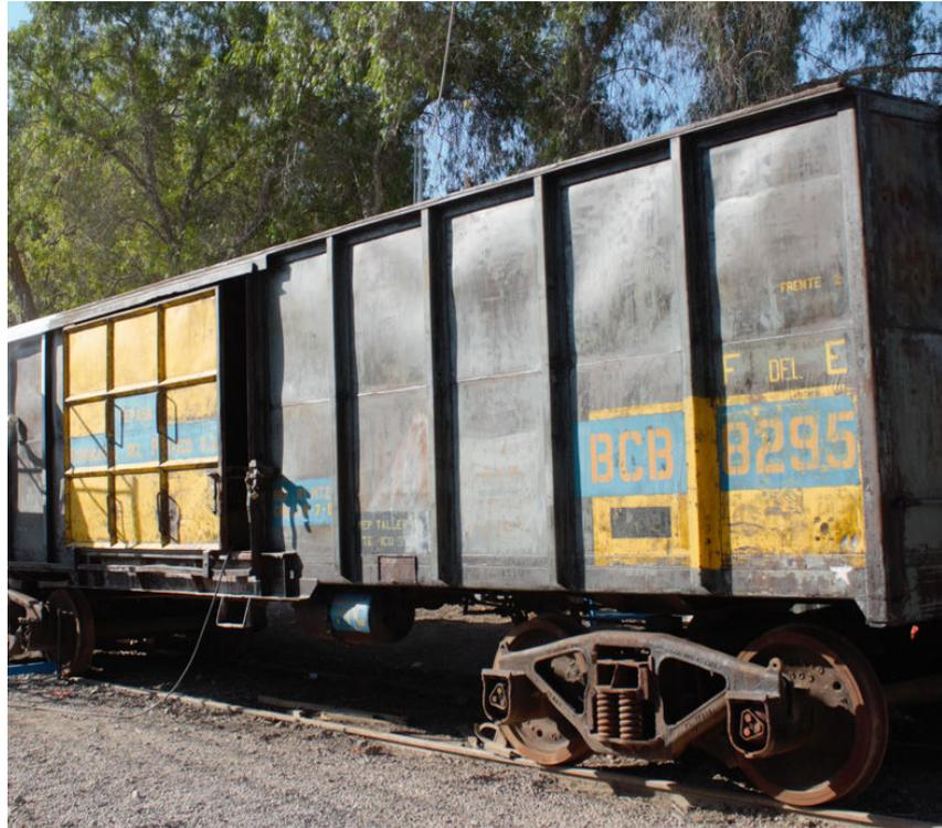
**Ilustración 24** - Carro bodega con decapante aplicado en su totalidad.
