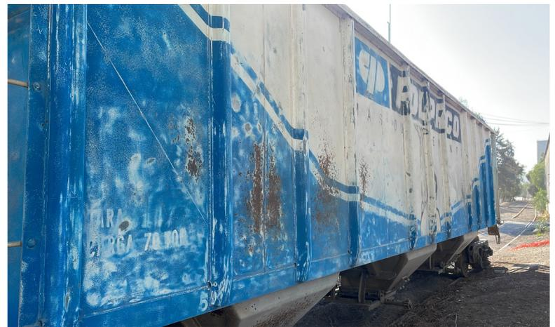
**Ilustración 41** - Carro tolva en proceso de lijado.
