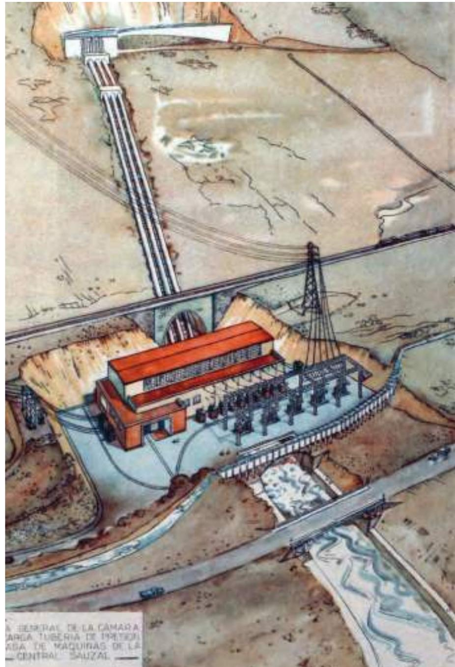
Fig 18. Ilustración de vista general de la cámara de carga, tubería de presión y casa de máquinas de la Central Sauzal.
