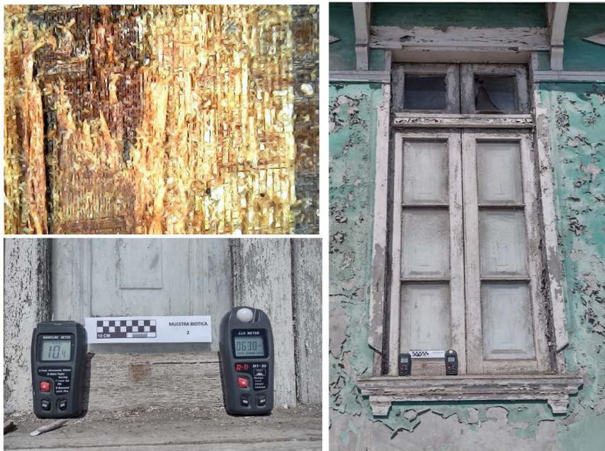
Microscopías 1000x; Abeto Douglas / medición Humedad relativa y radiación UV localizada
