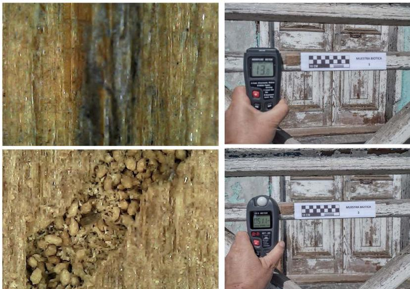
Microscopías 1000x; Abeto Douglas / medición Humedad relativa y radiación UV localizada
