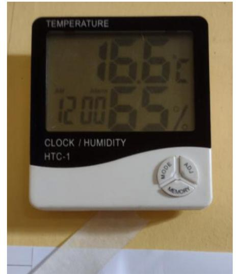
Medición promedio de Temperatura ambiente en la primera planta, durante tres días de registro en distintos horarios; 16.6 C°, de una mínima de 16. 1 C° una máxima de 17,3 C°. Medición promedio de HR 60 %, de una mínima de 56% a una máxima de 65 %.
