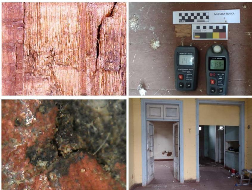
M 1600x; Abeto Douglas / medición Humedad relativa y Lumen / M 1600X Estrato pictórico / Vista general de la sección de la muestra "pavimentos"
